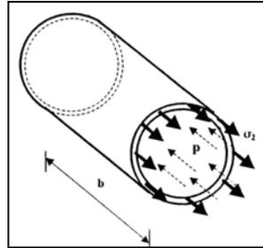
Figura 1.2 ESFUERZO LONGITUDINAL
