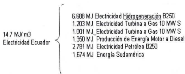
FIGURA 3.5 PROCESO DE ELECTRICIDAD ECUADOR PARA MSF
