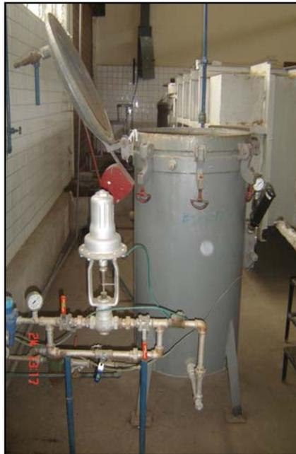
**GRÁFICO 2.1** Vista lateral del autoclave Vertical
