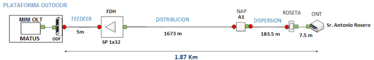
Figura 42. Diagrama esquemático de la red GPON
