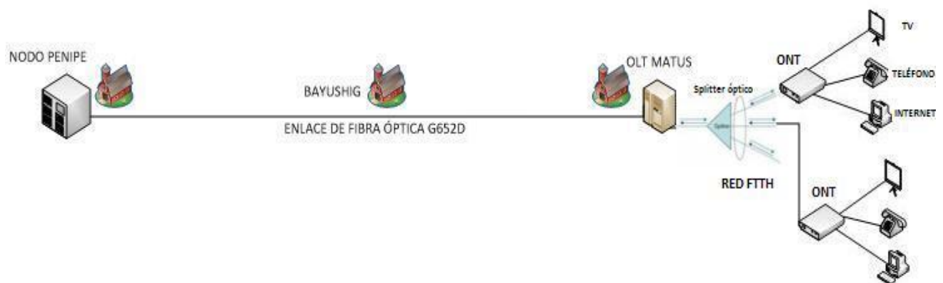
Figura 13. Esquema topológico del proyecto FTTH para Matus
