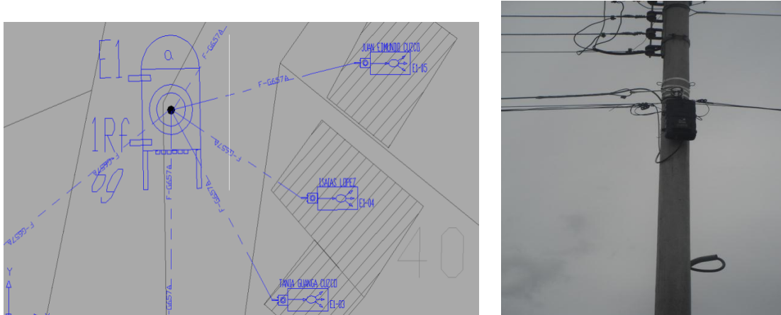
Figura 35. NAPs aéreas y su diseño en AutoCAD con acometidas
