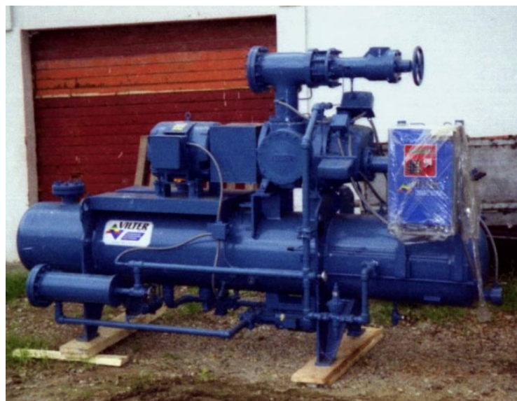
Figura 1.15. Compresor de Tornillo
