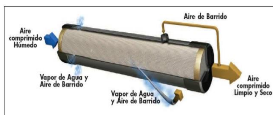
Figura 3.11 Secador de membrana.
