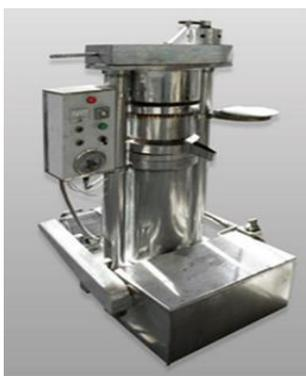
**FIGURA 2: PRENSA HIDRÁULICA AUTOMÁTICA CON GUÍAS
