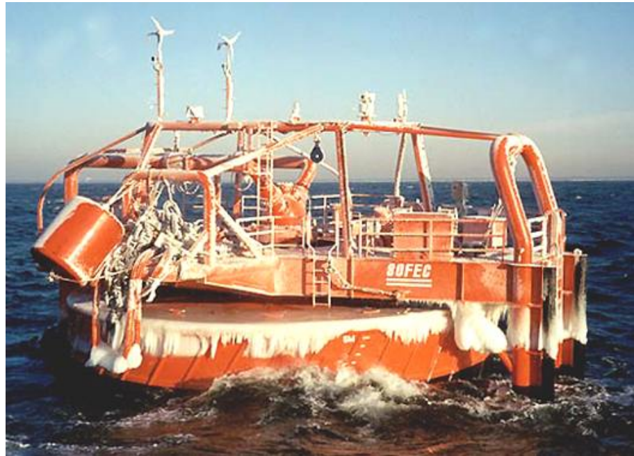
FIGURA 1.5. SISTEMA DE AMARRE POR MONOBOYA TIPO CALM.
