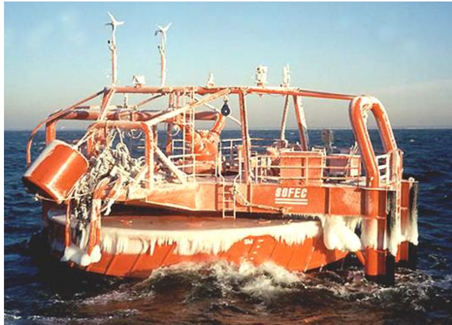
FIGURA 1.5. SISTEMA DE AMARRE POR MONOBOYA TIPO CALM.
