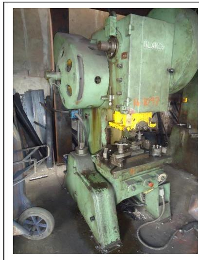
**Figura 2-37. Maquina troqueladora de 60 ton.**
