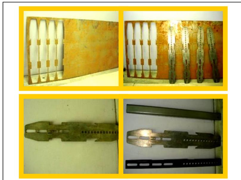
**Figura 2-2. Ensayos de manufactura por máquina a chorro de agua**
