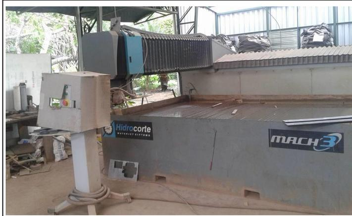
**Figura 2-36. Máquina de corte por chorro de agua**
