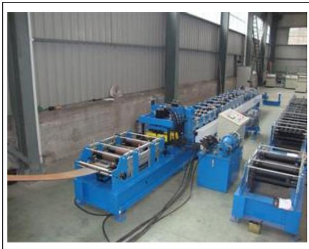
**Figura 2-33. Formadora perfil Z**
