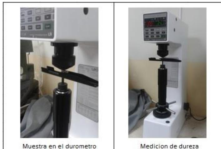
**Figura 2-14. Ensayo de dureza**
