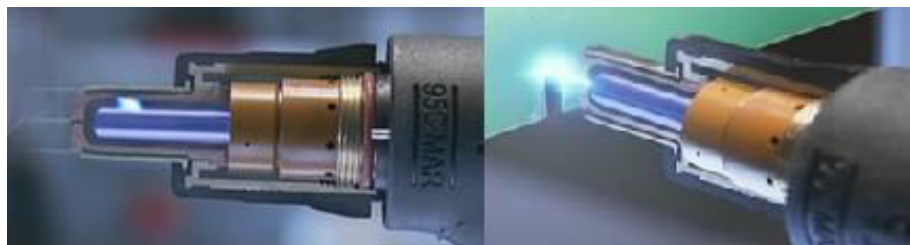
Figura 1.1 Proceso de generación de arco eléctrico (energía eléctrica) y plasma (energía térmica).
