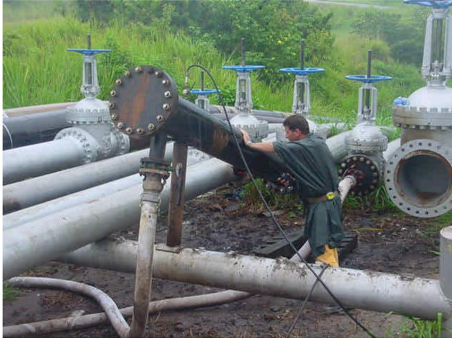
FOTO 1.- LANZADOR EN UNA OPERACIÓN DE LIMPIEZA
