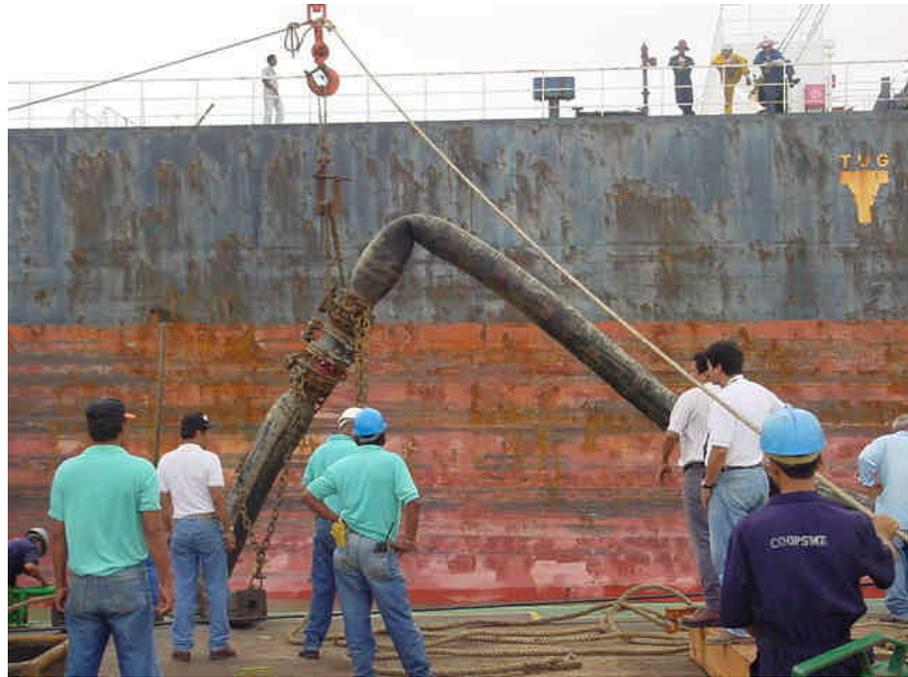
FIG. 2.4 CONEXIÓN DE MANGUERA ESTABLECIDA
