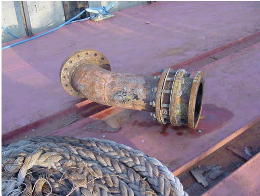
FOTO 11.- TRAMO UTILIZADO PARA CONEXIÓN DE MANGUERAS DE LÍNEA DE 14" Y LÍNEA DE 10"
