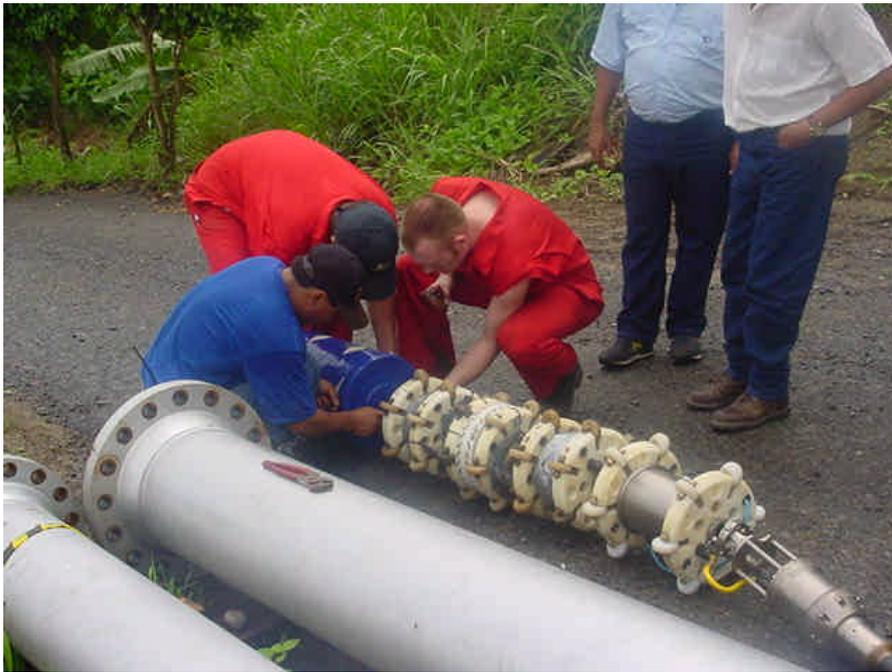
FOTO 4.- PIG DE INSPECCIÓN DE 12"
