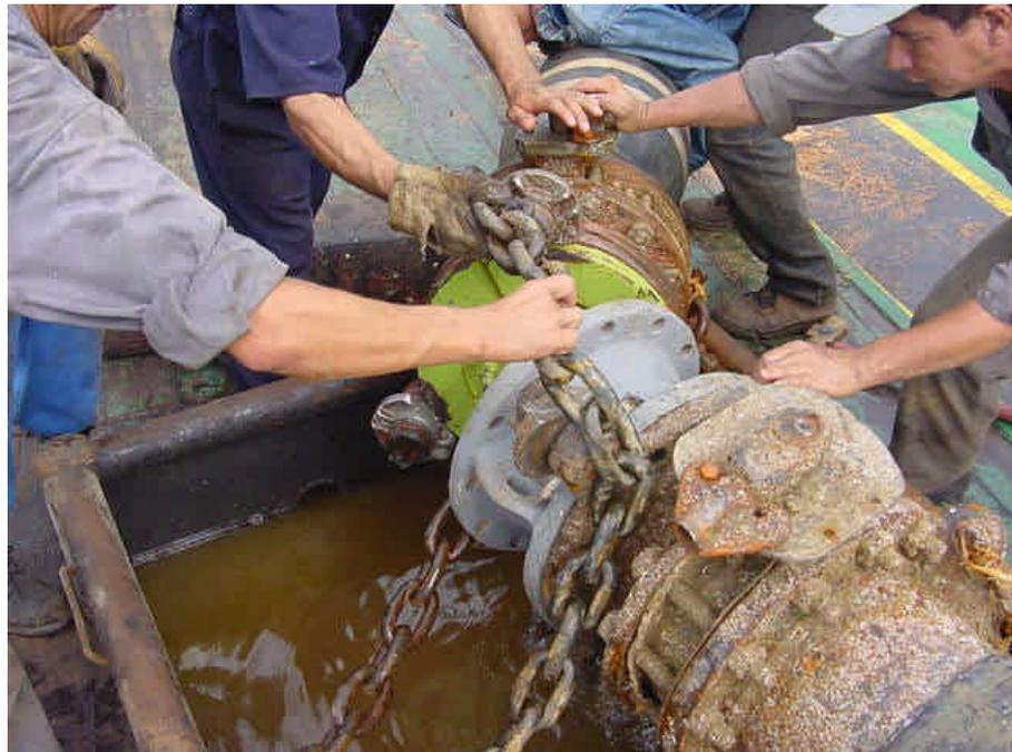
FIG. 2.3 OPERADORES DE REE ESTABLECIENDO CONEXIÓN DE MANGUERAS
