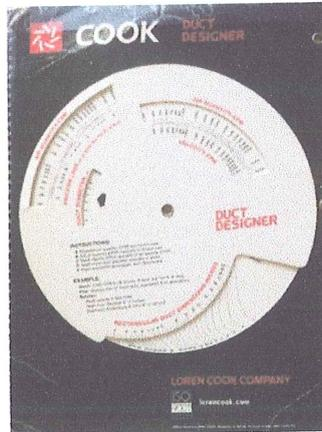
**FIGURA 3.57 TABLA PARA DIMENSIONAMIENTO DE DUCTOS**
