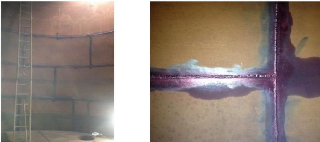
**Figura 3.2 Prueba de hermeticidad en el interior del tanque y aplicación de tintas penetrantes en el cordón de soldadura.**
