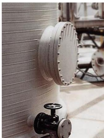
**Figura 1.4 Shell Manhole**
