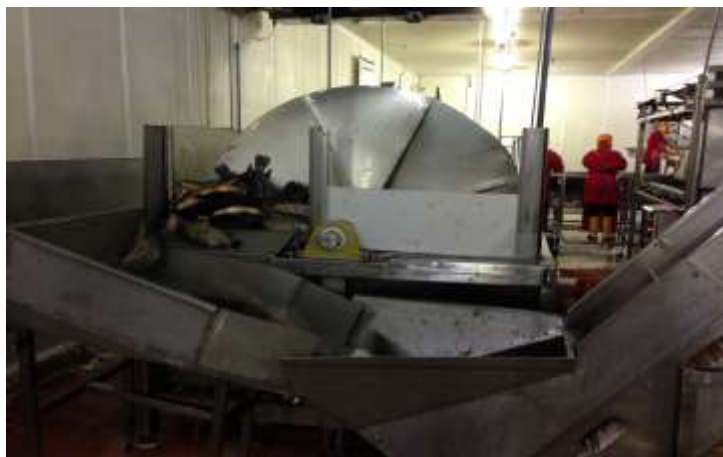
FIGURA 1.6 TANQUE DE DESANGRADO
