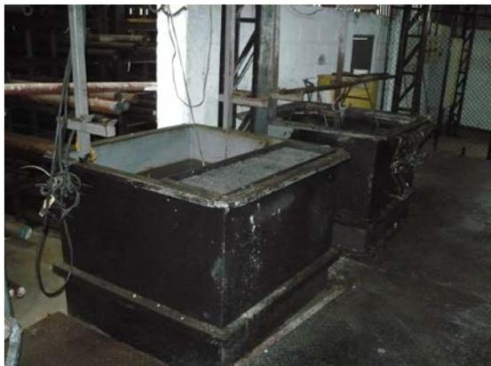
FIGURA 2.23 TANQUES DE AGUA Y ACEITE
