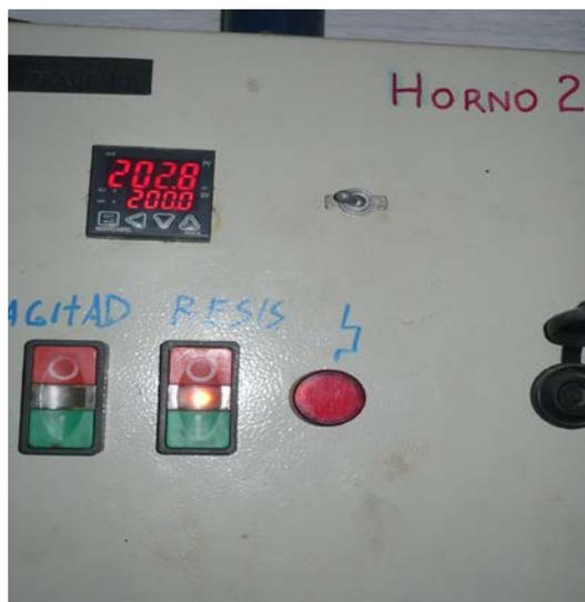
FIGURA 2.16 PANTALLA DEL PIRÓMETRO
