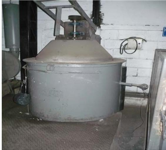
FIGURA 2.19 HORNO DE AIRE FORZADO 4
