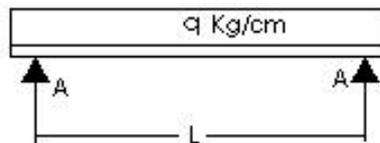
**Figura 3.21:** Viga con distribución uniforme de carga
