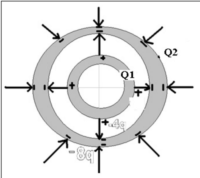
Dos cascarones esféricos conductores tienen carga neta  $Q_1$  y  $Q_2$ . El diagrama muestra la distribución de las líneas de fuerza para los dos conductores ¿Cuál es la relación de carga  $Q_2/Q_1$ ?
