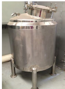
Figura 5.6.- Reactor enchaquetado - Capacidad 0.5m 3
