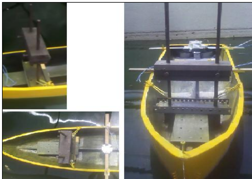
Figura 8. Sistema usado para variar la altura metacéntrica (GM)
