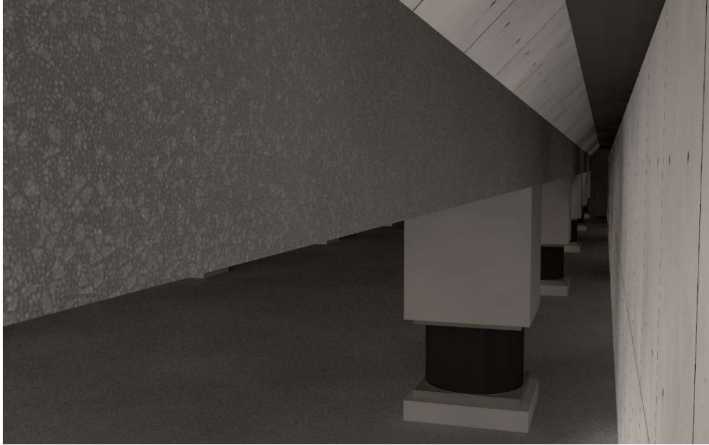
Figura 5.39. Vista 3D de los aisladores sísmicos de base, pantallas de hormigón, ménsula y junta sísmica. Fuente: Autores, 2016.
