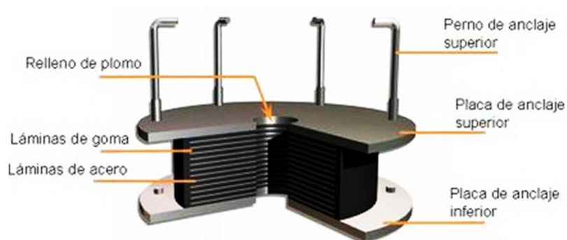
Figura 5.23. Componentes de un aislador sísmico de base. Fuente: Madrid, s.f.
