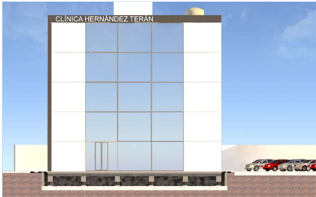
Figura 5.37. Corte 3D, vista de la edificación con sus aisladores sísmicos de base. Fuente: Autores, 2016.
