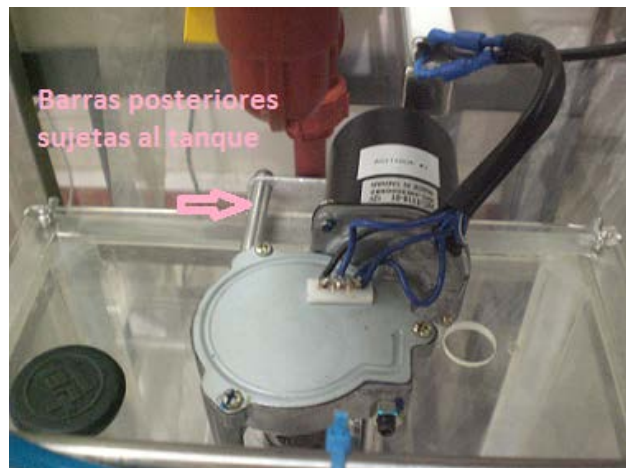
Figura 3.13 Vista superior del motor acoplado al agitador
