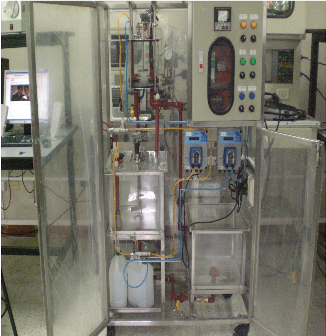
Planta piloto de neutralización continua de aguas residuales.
