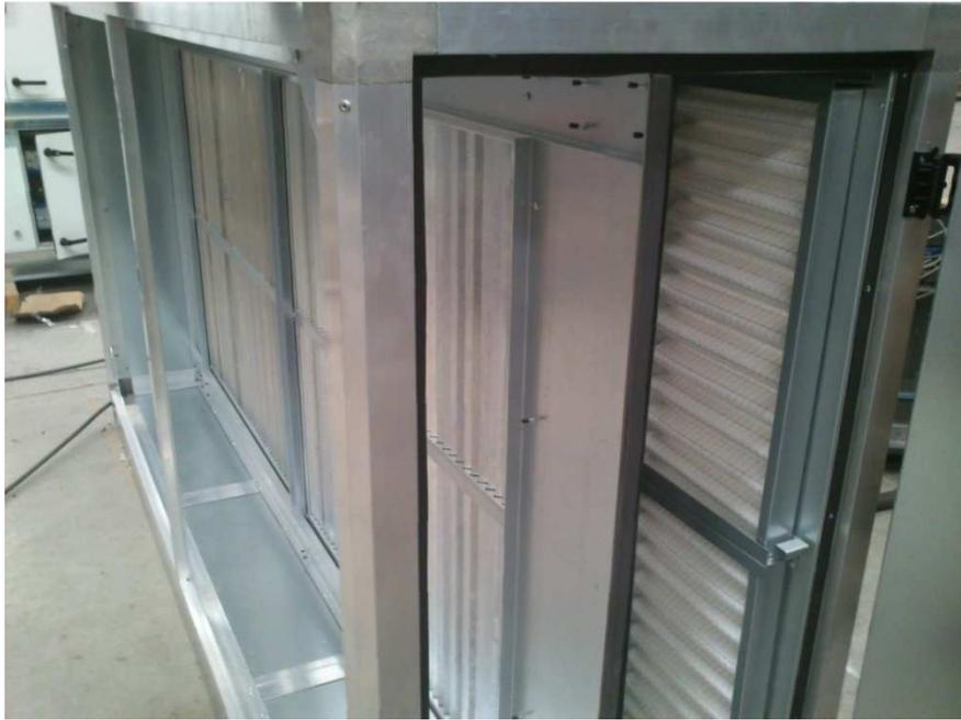
**Foto 1.3.** Detalle De Oscurecedor y Filtros.
