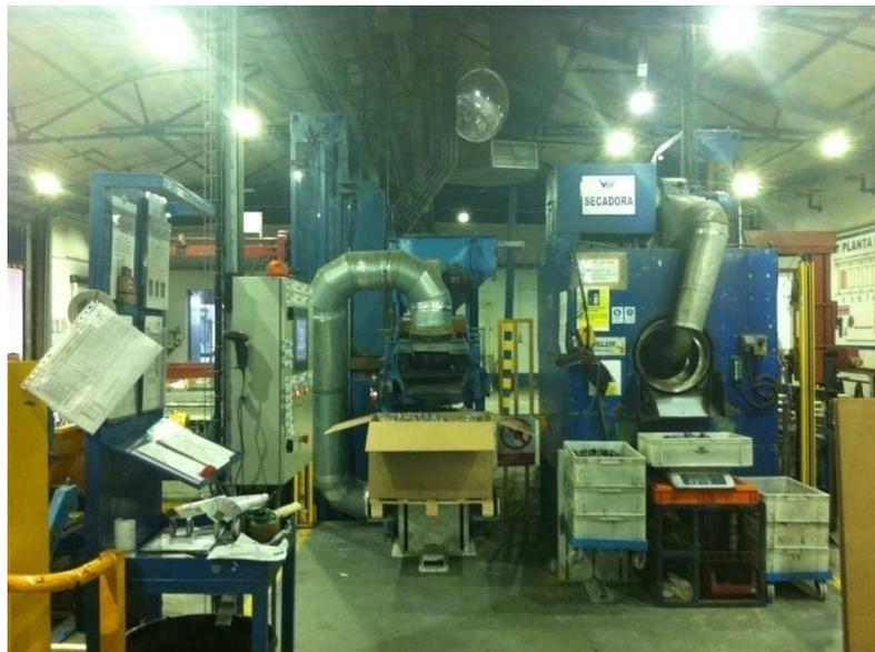
**Foto 3.10.** Equipos con el nuevo conducto.
