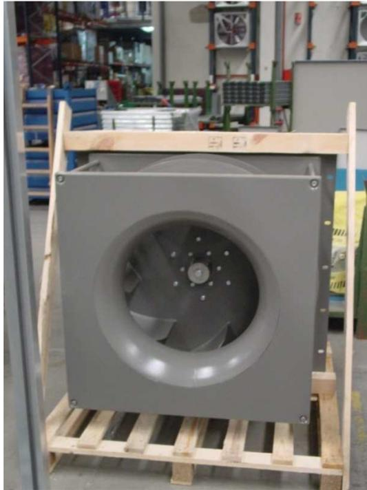
**Foto 1.11.** Lado Aspiración Del Ventilador.
