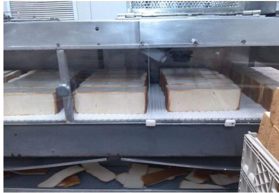
Figura 2.5. Máquina Túnel Acondicionador (MTA).
