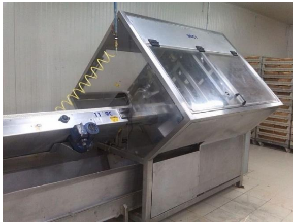
Figura 2.1. Máquina Descortezadora MD
