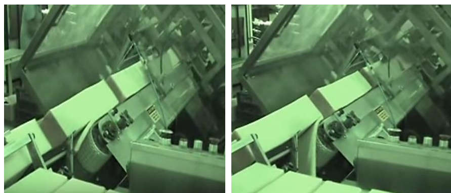
Figura 2.9. Sistema Riel-Guía estáticos. Línea UBE Model 3100.
