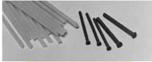
Fig. 2-29 Varillas y varillitas resistentes a la abrasión
