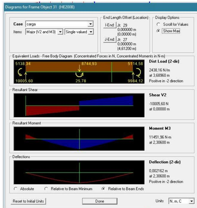
Figura de valores máximos de los diagramas de las vigas HEB200 de las paredes frontal y posterior.
