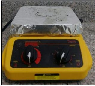
Figura 23. Plancha con Agitación
