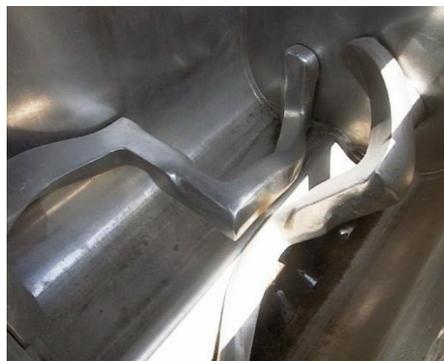
**FIGURA 2.9 MEZCLADOR SIGMA**
