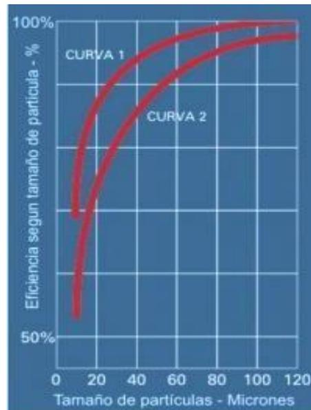
**FIGURA 2.13 EFICIENCIA DE UN CICLÓN**
