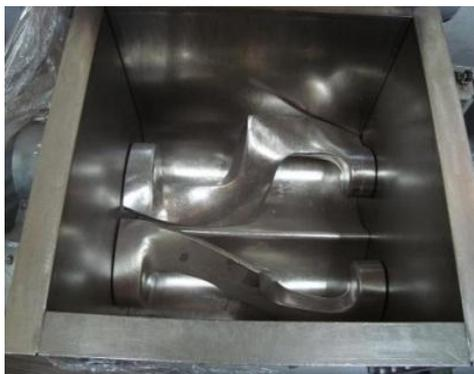
**FIGURA 2.10 MEZCLADOR BARRA Z**
