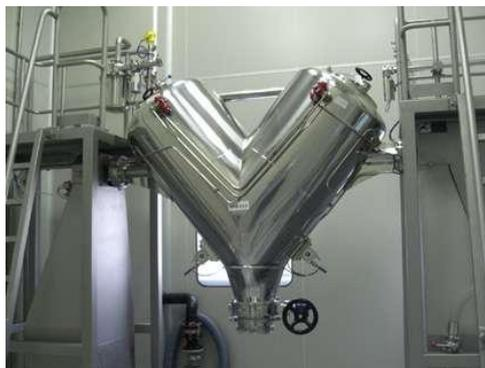
**FIGURA 2.4 MEZCLADOR EN V**
