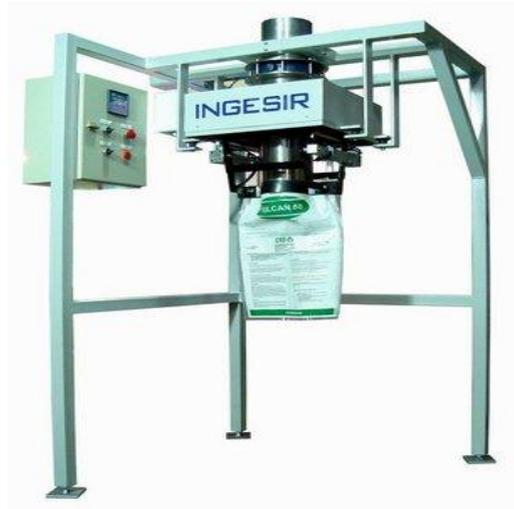
**FIGURA 3.9 EMBOLSADORA DE CARGA POR GRAVEDAD**
