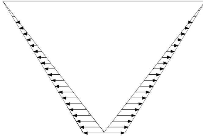
**FIGURA 3.3 PRESIÓN EN LAS PAREDES DE LA TOLVA**
