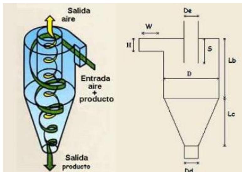
FIGURA 3.8 ESQUEMA DEL CICLÓN <sup>(5)</sup>
