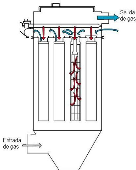
**FIGURA 2.16 FILTRO DE MANGAS TIPO PULSE JET**
