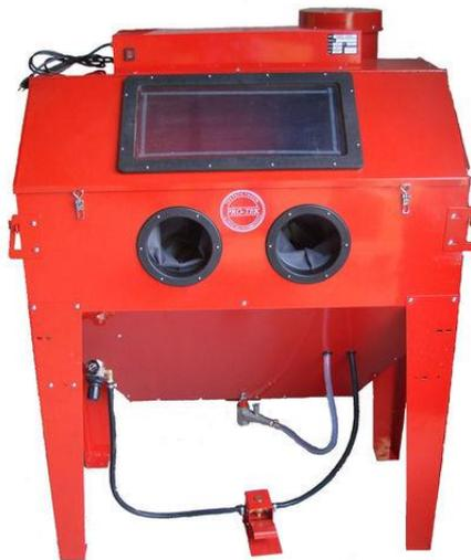
**Figura 1.1 Cabina de Sandblasting**
