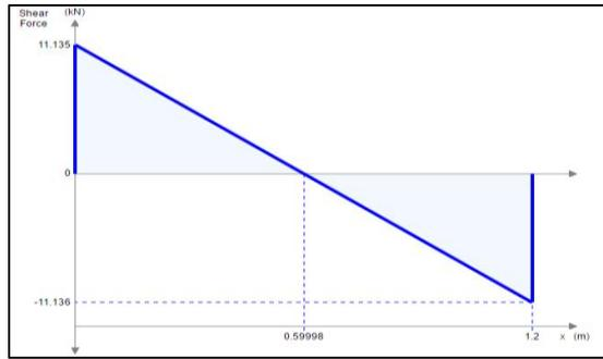
Figura 2.7 Diagrama de Fuerzas de la viga de 1200mm
