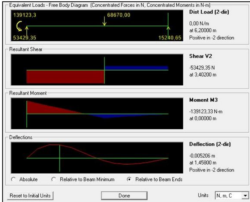
Figura B-9 Diagramas de fuerza cortante y momento flector del segundo claro de las vigas longitudinales para el Caso 3.
