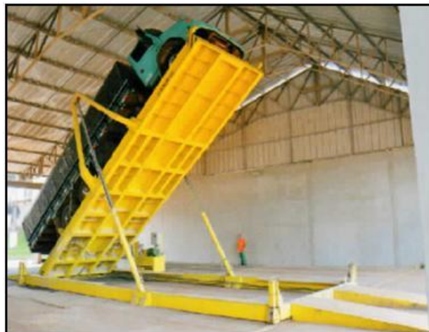
Figura 1.3 Sistema de descarga fijo a sobrepiso.
