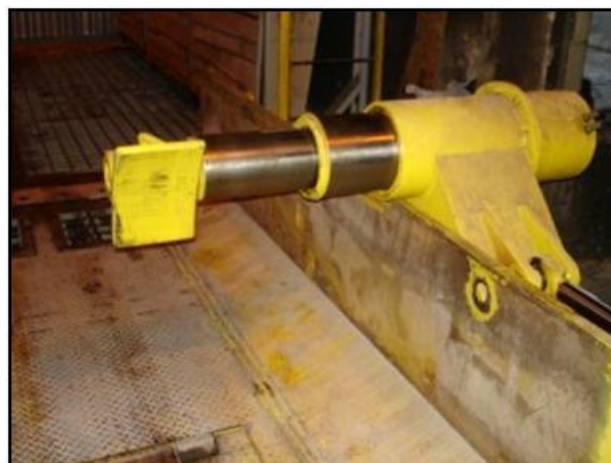
Figura 1.9 Aseguramiento de pistón móvil.
