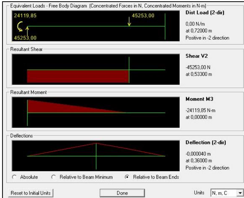
Figura E-2 Diagrama de fuerza cortante y momento flector, Viga 1.
