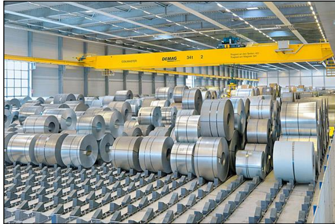
Figura 1.2. Bodega de almacenamiento de bobinas
