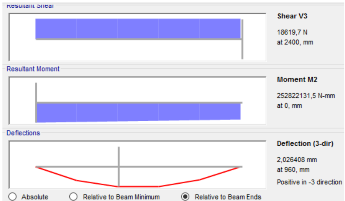
Figura 2.57. Diagramas: V vs X; M vs X de la Viga Conectora Recta en el plano x-y
