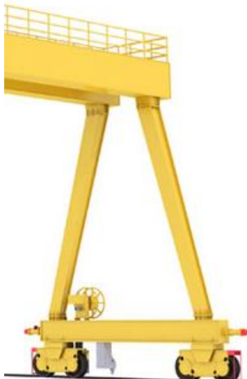
Figura 2.10. Disposición de Columnas en la Grúa Pórtico
