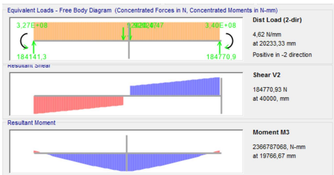
Figura 2.21. Diagramas: V vs X; M vs X; de la Viga Principal en el plano y-z
