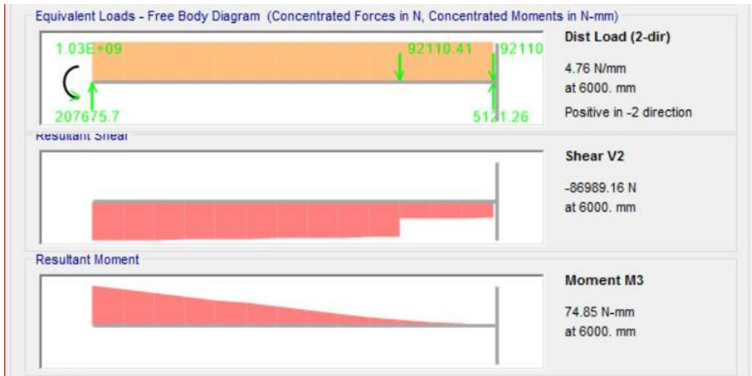
Figura 2.31. Diagramas: V vs X; M vs X en el voladizo
