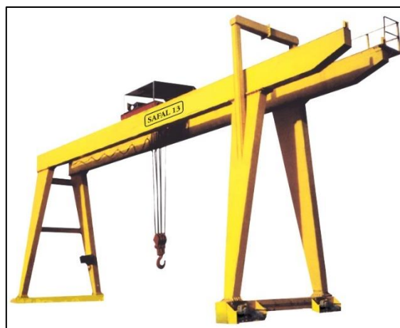
Figura 2.2. Grúa Pórtico con Voladizo en un Extremo.
