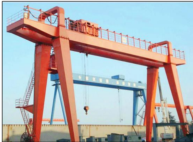
Figura 1.4. Grúa Pórtico con Voladizo
