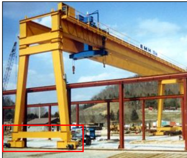
Figura 2.70. Disposición de los testeros en una grúa pórtico
