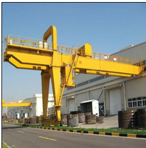
Figura 1.6. Grúa Pórtico con Voladizo con Marco de Soporte único
