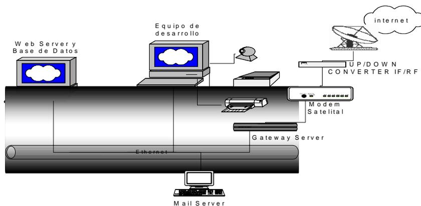
*Figura 3.0 Diagrama esquemático de la red interna*
