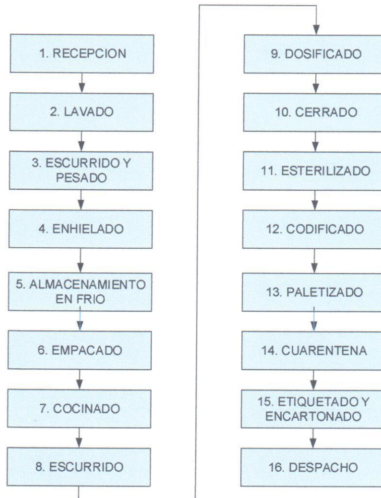
Figura 1: Diagrama de Proceso para la elaboración de sardina en conservas
