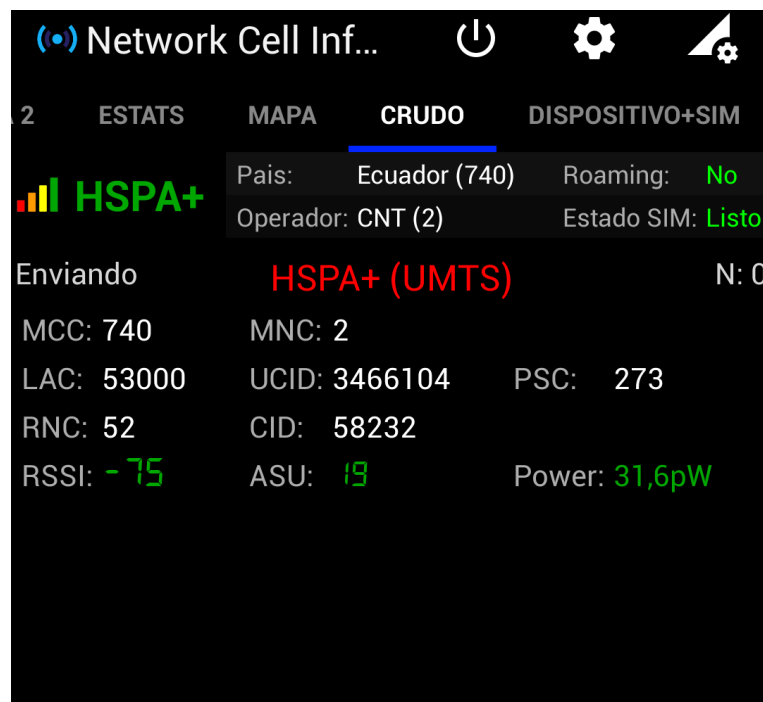
Figura 3.26: Información sobre otros aspectos técnicos de la red celular de la operadora CNT
