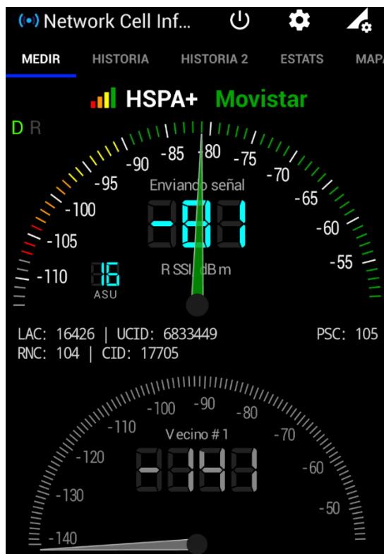
Figura 3.1: Indicador de fuerza de la señal recibida en Chanduy por parte de la operadora Movistar
