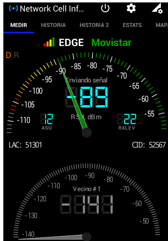
Figura 3.27: Indicador de fuerza de la señal recibida en Las Naves por parte de la operadora Movistar
