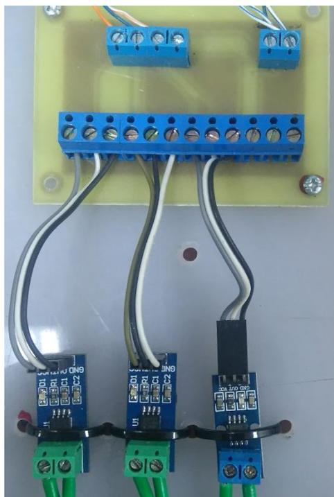
**Figura 3.11 Sensores de corriente y placa de conexiones**
