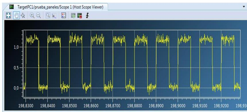
**Figura 4.12 Corriente de la carga al 40%**
