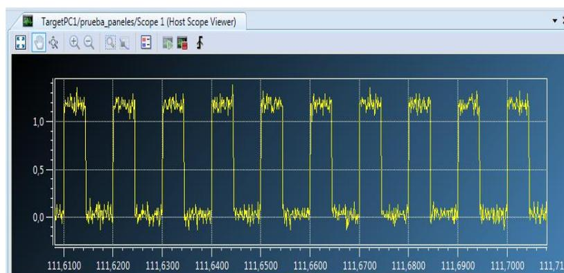
**Figura 4.6 Corriente en la carga al 30%**
