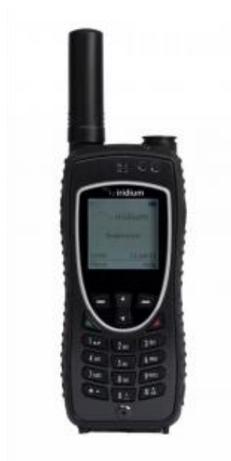
Figura 2.15: Teléfono móvil satelital Iridium [26]
