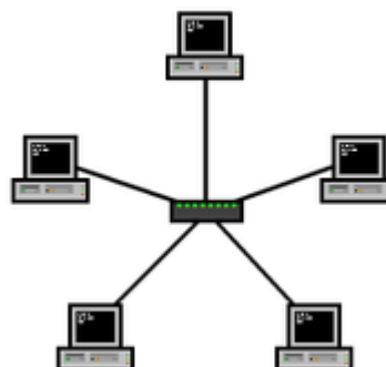
Figura 2.8. Un conmutador en el centro de una red en estrella.
