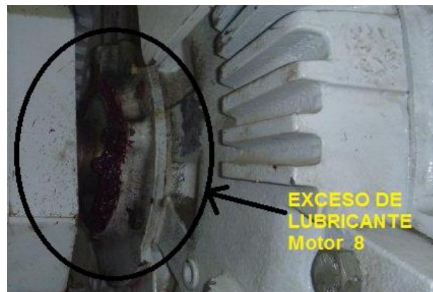
Figura 2.5.- exceso de lubricante del lado del acople del motor.
