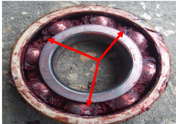
Figura 2.3.- rodamiento que muestra la degradación de la grasa.
