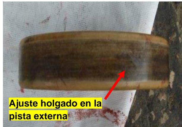
Figura 2.4.-pista exterior del rodamiento del lado del acople.
