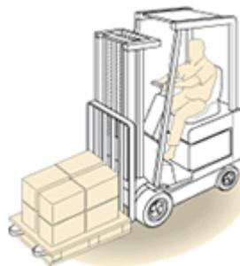
Figura II-8 MONTACARGAS CONTRABALANCEADO
