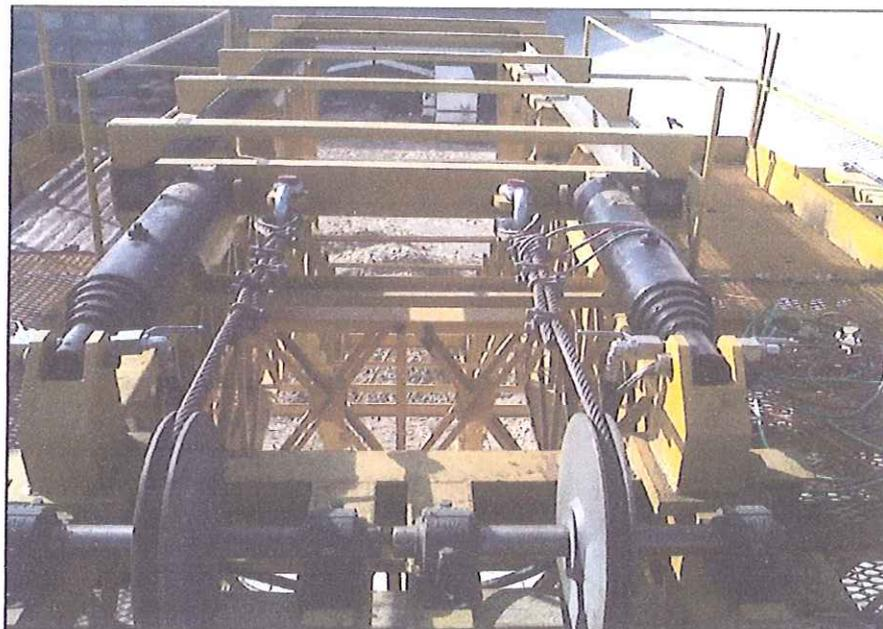
**FIGURA 1.3 CILINDROS DE 5 ETAPAS PARA IZAJE DE VAGÓN.**
