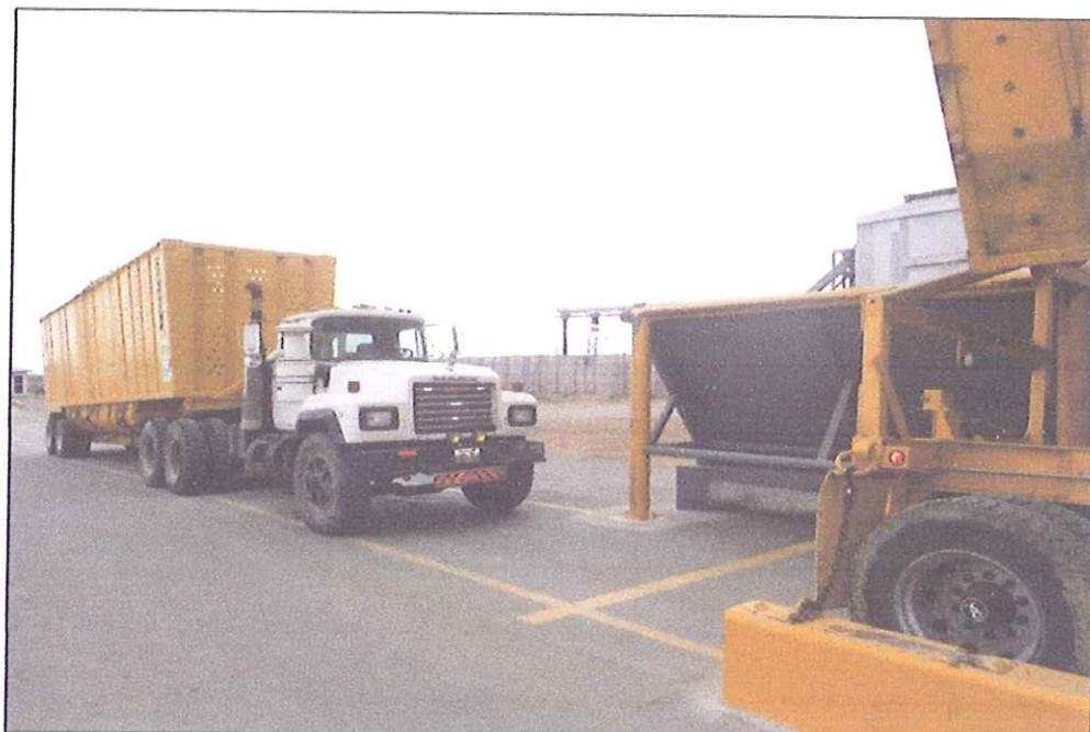
**FIGURA 1.1 VAGÓN LISTO PARA DESCARGAR CAÑA.**
