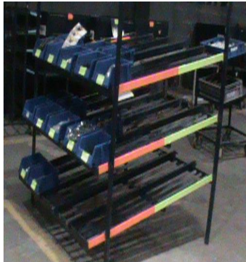
Fig. 12. Señales implementadas para controlar el flujo de partes.
