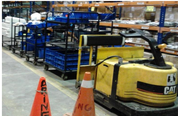
Fig. 13. Uso de Tuggers para el despacho de materiales a las líneas.
