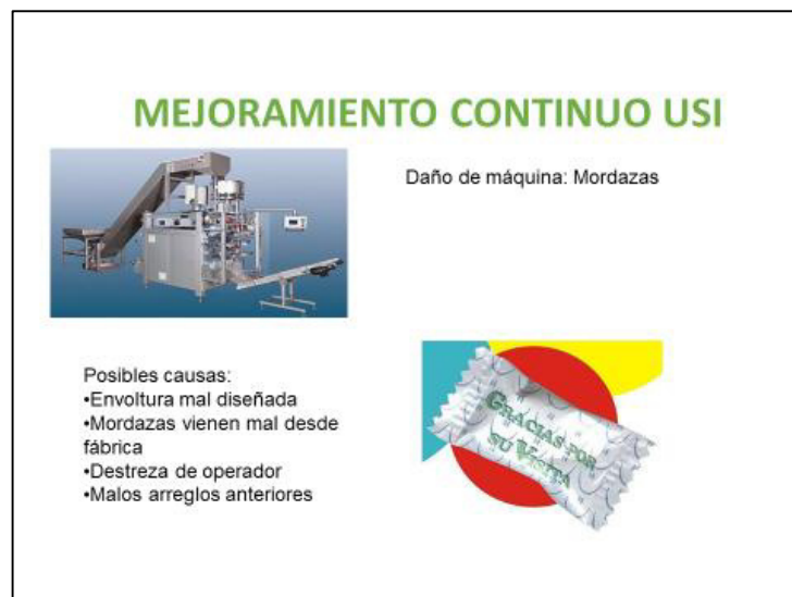
Figura 4.2 Ejemplo de posibles causas de daños.
