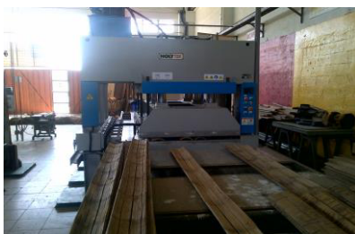
Figura 9: Prensa para fabricación de tableros o paneles
