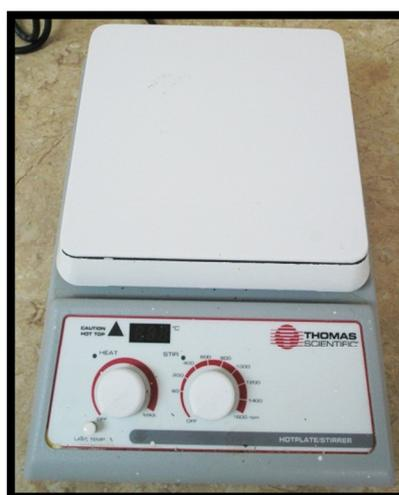
**Ilustración 11.** Agitador magnético con calentamiento (Marca Thomas Scientific, Modelo n/d) (Fuente: Autor).
