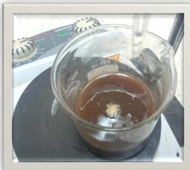
***Figura 2: Muestra tratada con peróxido de hidrogeno***
