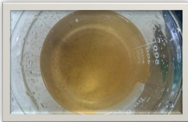
**Figura 8: Líquido extraído de la muestra tratada con cal y polielectrolito**
