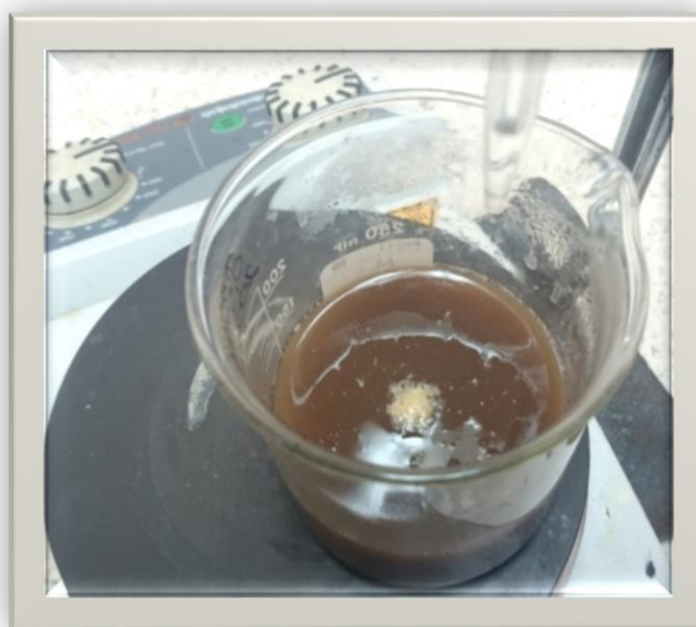
Figura 2: Muestra tratada con peróxido de hidrogeno
