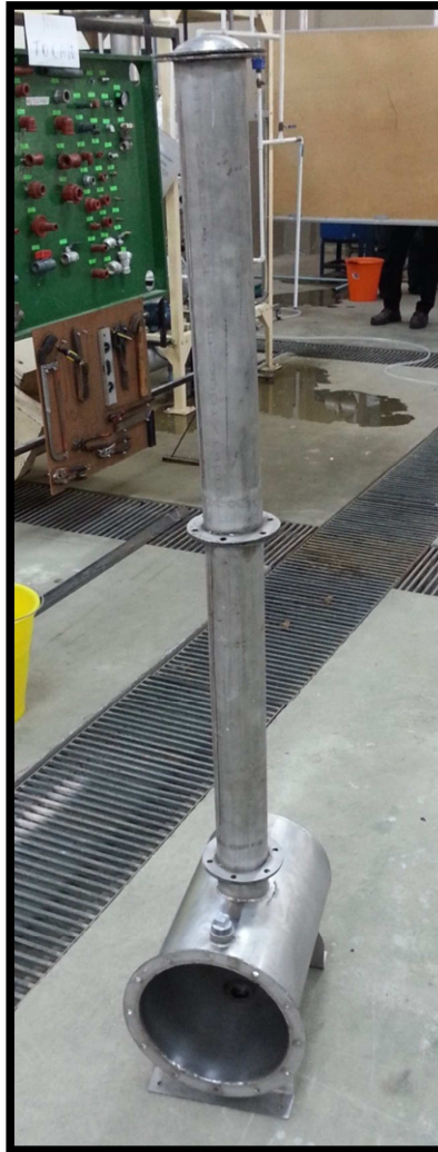
Figura 5.1. Columna de Destilación y Calentador Conectado por Bridas
