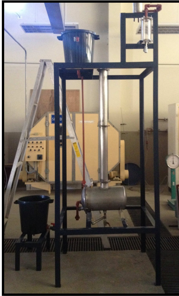
Figura 5.4. Estructura de Soporte para Unidad de Destilación
