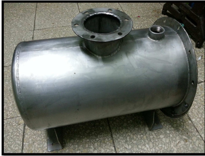
Figura 5.2. Calentador Empleado en Unidad de Destilación
