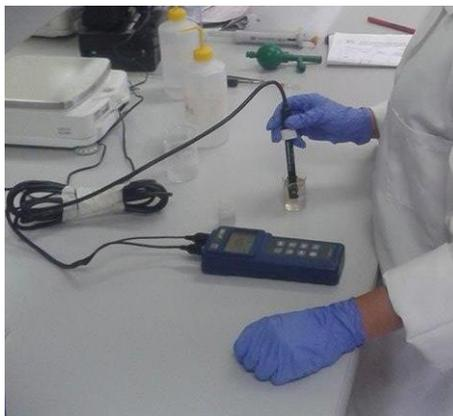
**Figura 3.2.1.** Determinación de pH del sedimento.
