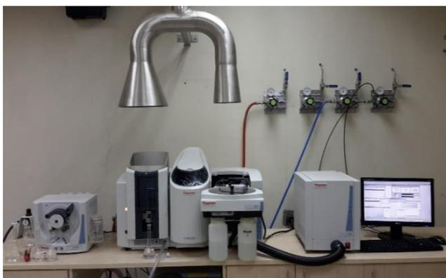
**Figura 3.2.6.** Espectrofotómetro de Absorción Atómica
