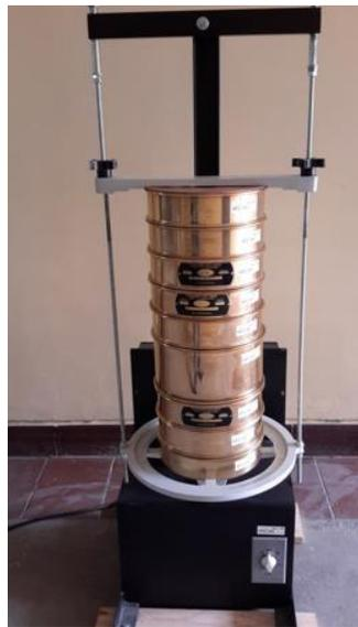
**Figura 3.2.5.** Tamización en seco del sedimento
