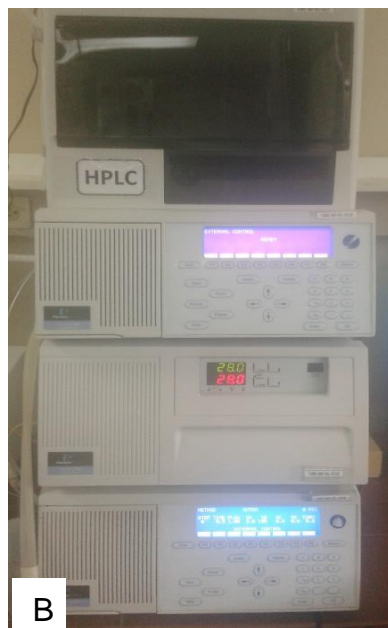
Figura A6. 1. A) Viales con las muestras de extracto clarificado para analizar en el HPLC B) Equipo de Cromatografía Líquida de Alta Resolución (HPLC)
