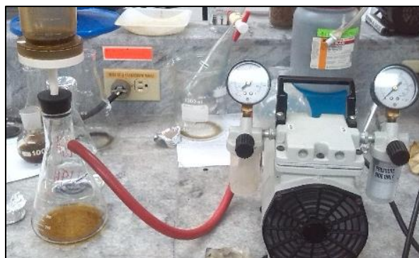
Figura 4.16. Filtración al vacío del extracto tratado con carbón activado
