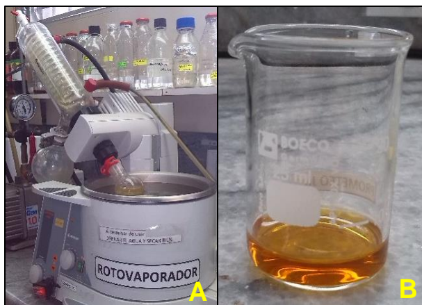
Figura 4.17. A) Roto evaporación de solvente, B) Extracto concentrado
