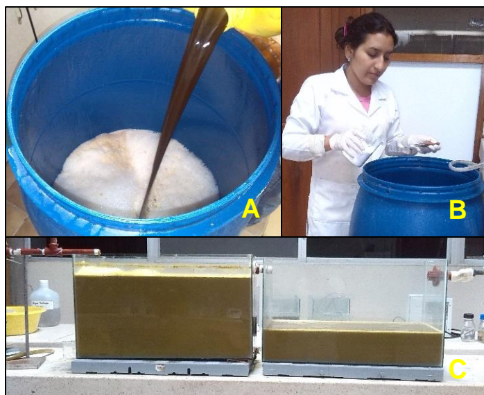
Figura 4.8. A) Preparación del extracto crudo, B) Adición de \text{CaCl}_2 , C) Coagulación/floculación del extracto de Stevia
