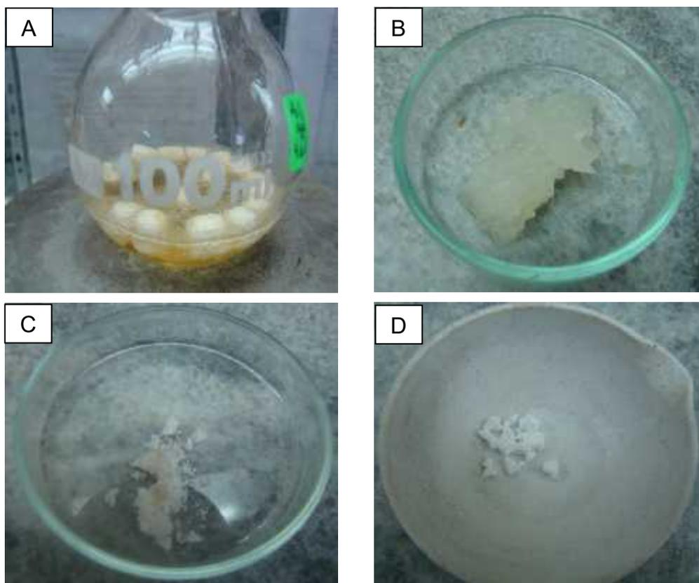
**Figura A.4. 4** Contenido de celulosa A) muestra puesta a reflujo con HAc y  $\text{HNO}_3$  B) muestra filtrada C) muestra seca D) muestra incinerada. Elaborado por: Autor, 2014
