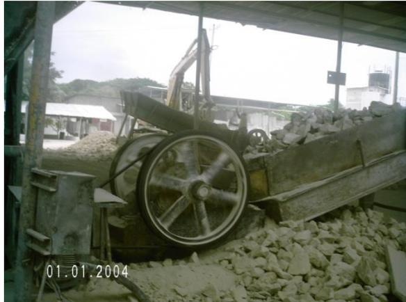
**FIGURA 3.2. TRITURADOR PRIMARIO**
